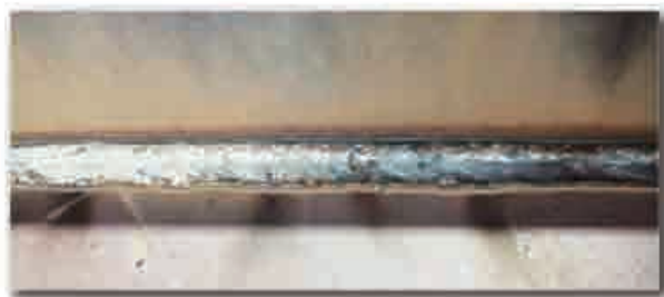
背部熔透效果 材质:Q345 工艺规范:打底焊340A-360A
